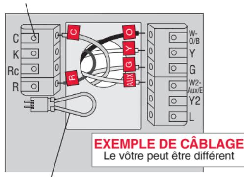
Retirez la boucle de raccordement **SEULEMENT** si les fils **R et Rc** sont tous les deux présents.
